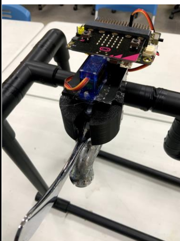
圖三: microbit 與水龍頭控制關閉
