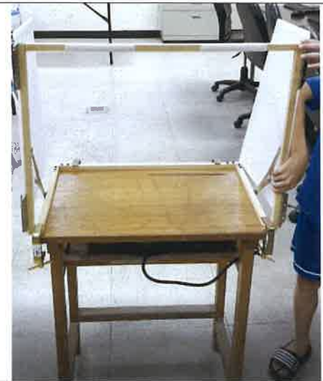
圖3.安裝升降防疫遮罩側板
