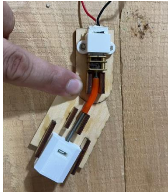
圖 18.研究與調整 N20 馬達推進煞車皮的方向與角度
