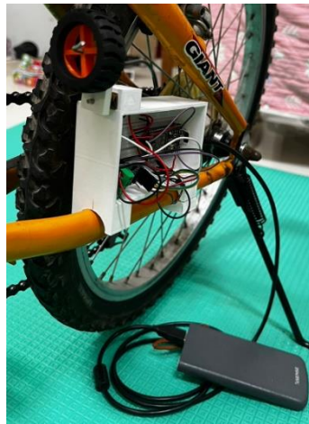
圖 20.目前完成的「腳踏車遠端減速器」
