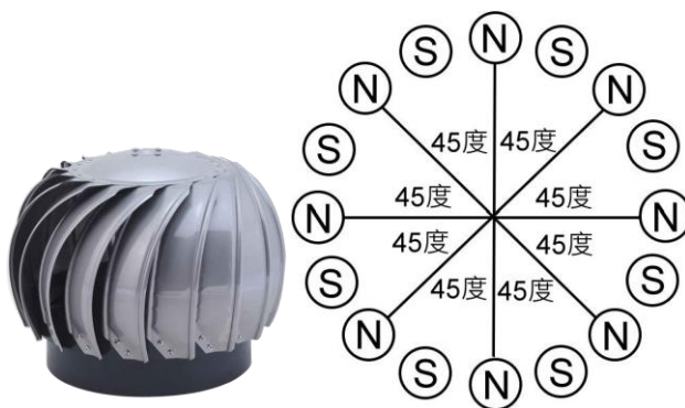
通風球內磁鐵排列方式與充電圖示。
