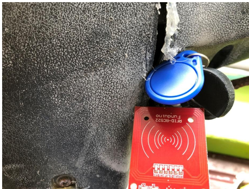
機車啟動時，藍色扣環與感測器錯開，此時無動作。
