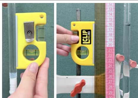
▲圖 1-20:使用水平儀確認透明管、尺規是否與桌面保持垂直。
