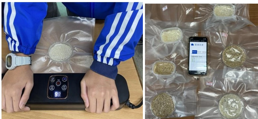
圖二，實驗使用的家用真空機，螢幕上顯示抽真空秒數，右圖顯示無漏氣狀況。
