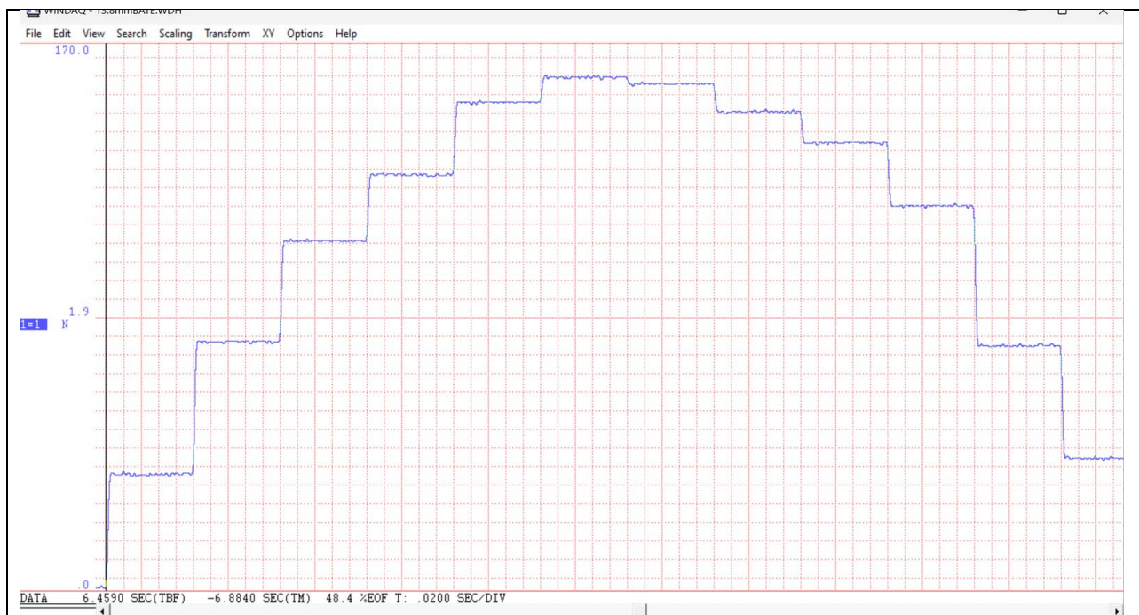
圖 2 3、B 藥柱 13.8mm DataQ 實際推力數據 (來源 :由作者擷取自 DataQ)
