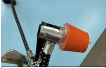
團隊拍攝之實驗照片 -自製打氣瓶塞
