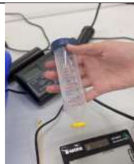
圖3-3 利用0.22微米過濾水盆中的水
