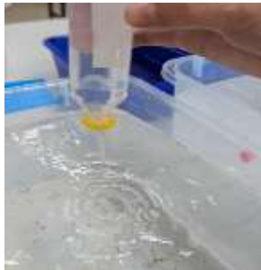
圖4-1：用 0.22\ \mu\text{m} 濾網把每一盆水都進行過濾
