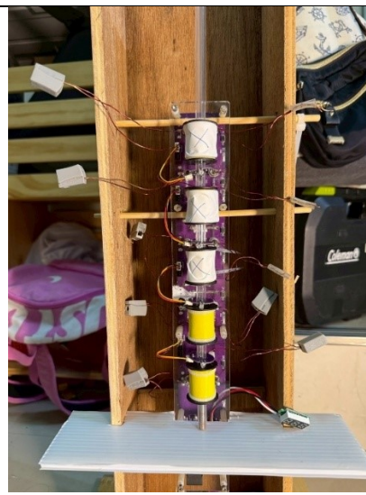
圖48 不同線圈級數(利用膠帶 X 區別無用線圈)
