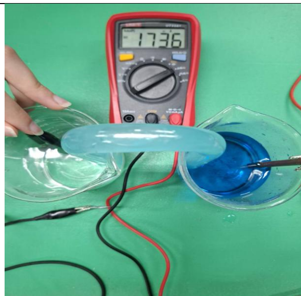
電極組合: 鋅片 *2 /銅棒 最大電流1736
