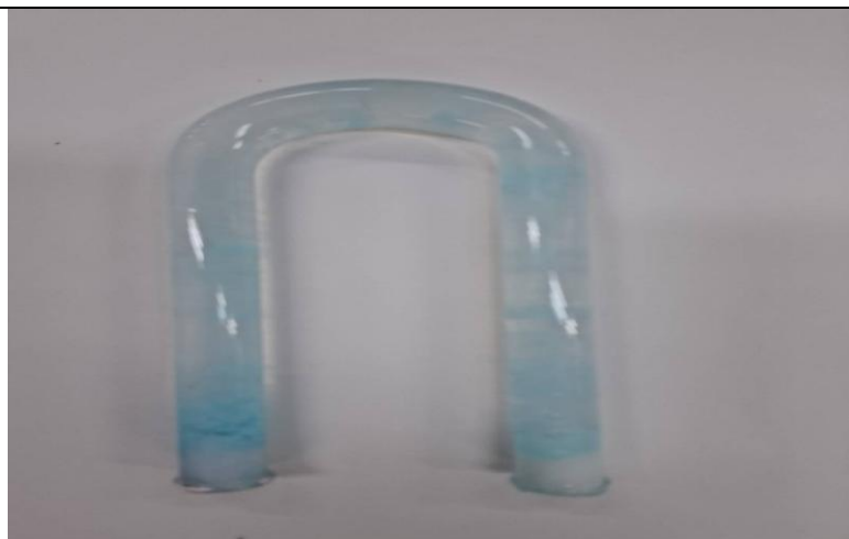
鹽橋使用後產生淡藍色結晶物質:推測是硫酸銅或硝酸銅
