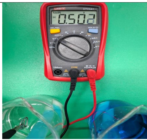
電極組合: 鋁製拉環 /銅棒 電壓0.502
