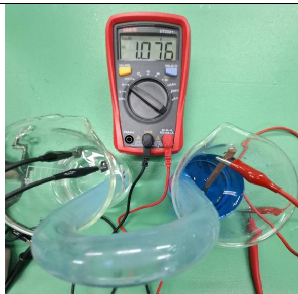
電極組合: 鋅片 *2 /銅棒 電壓1.076
