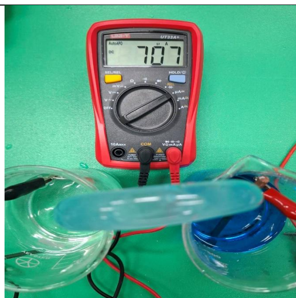
電極組合: 鋁製拉環 /銅棒 最大電流707
