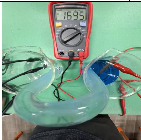
電極組合: 鋅片*2 /銅棒 最大電流1695
