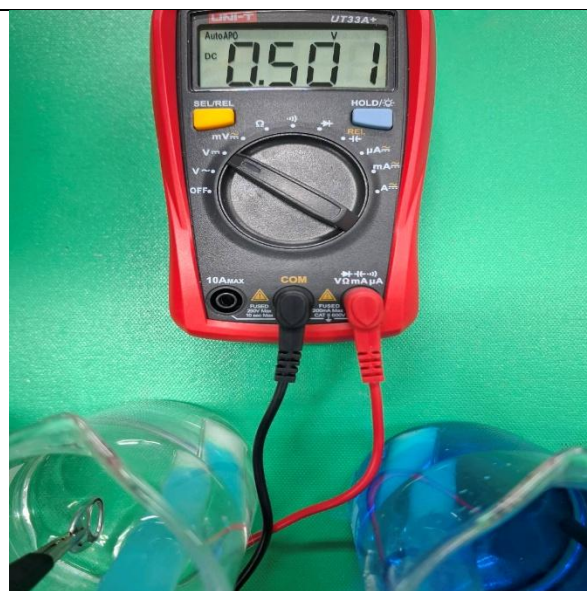
電極組合: 鋁製拉環 /銅棒 電壓0.501
