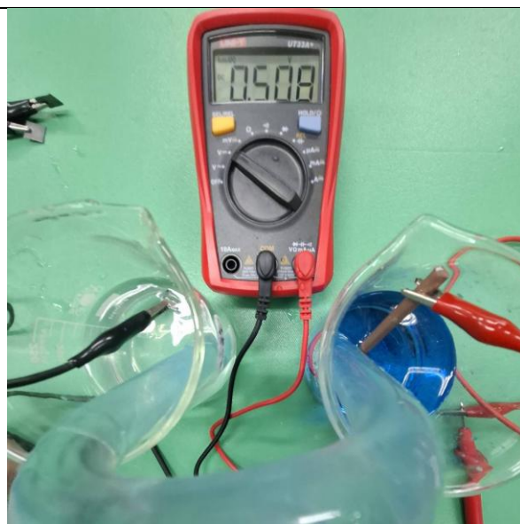
電極組合: 鋁製拉環 /銅棒 電壓0.508
