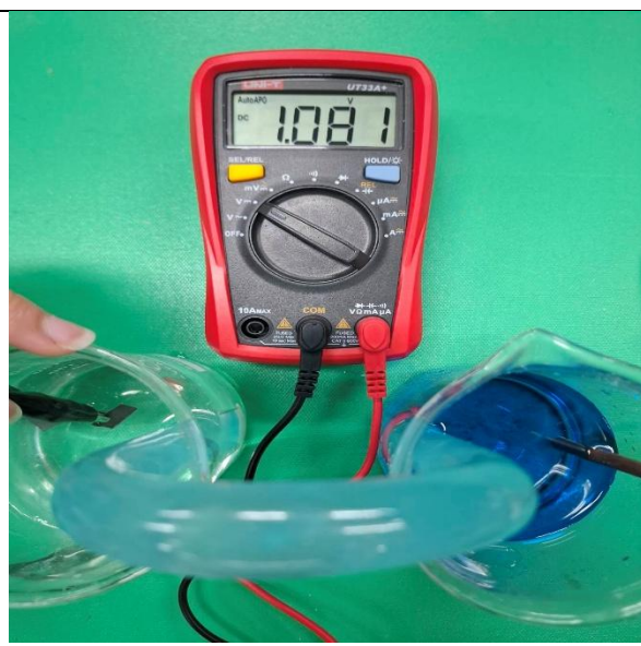
電極組合: 鋅片*2 /銅棒 電壓1.081
