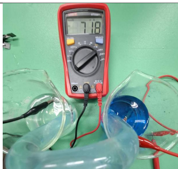
電極組合: 鋁製拉環 /銅棒 最大電流718
