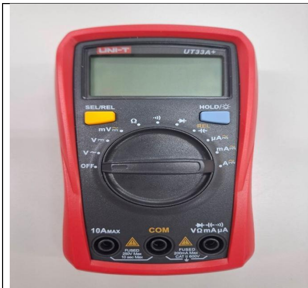
三用電表 以微安培 \mu A 為測量單位
