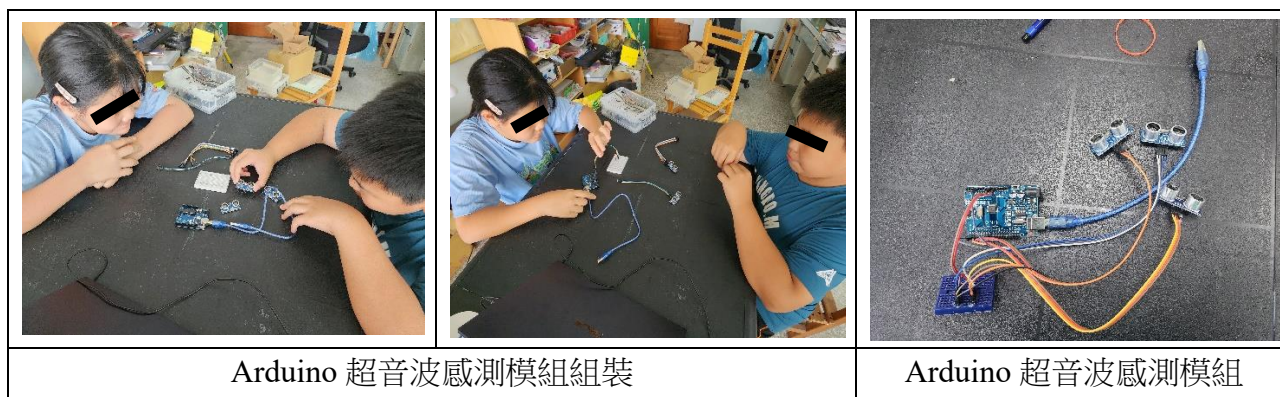
圖 10 Arduino 超音波感測模組的組裝(老師、學生拍攝)
