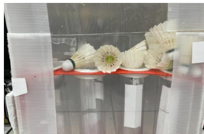
圖 6-2-2 新球卡在 7.3cm 孔口無法落入的卡球現象 (指導教師拍攝)
