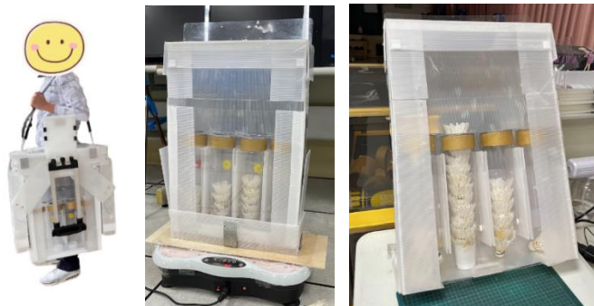
圖 1-2 左：裝置輕便好攜帶的設計特色(指導教師拍攝)；中、右：排列整齊球頭朝下的羽球，可直接填入發球機(指導教師拍攝)
