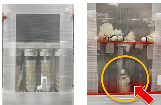
圖 6-1-4 7cm 孔徑排序 100% 正確 vs 8cm 孔徑排序失敗（有球羽毛朝下）對比（指導教師拍攝）
