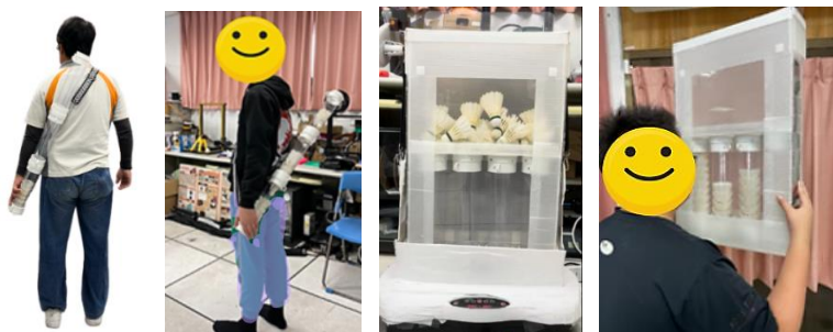
圖 5-4 左、中：球桶組裝成後揸式手動發球桶；右：機器震動與手動雙模式實際運作（指導教師拍攝）
