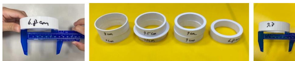
圖 6-1-2 3D 列印製作之各孔徑底盤（左至右：6.8cm、7.0cm、7.5cm、8.0cm），共 4 種規格；其中 7.3cm 孔徑於實驗二加入測試，實驗一使用 6.8/7.0/7.5/8.0cm 四種規格（作者製作並拍攝）
