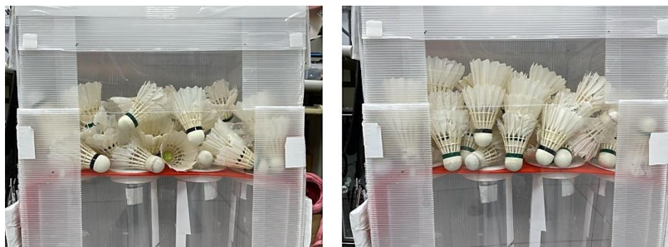
圖 4-2 左：未搖晃前球況平均分布；右：經過搖晃後，球量過多底部筒口堵塞，上層球雖已翻轉完成卻無法落入集球筒中（指導教師拍攝）
