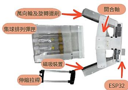
圖 5-1 零件組成及設計圖—含集球器（68x75cm）、集球托盤（61x43cm）與伸縮拉桿（95cm）規格(作者繪製)
