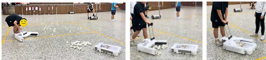
步驟 1：放置集球托盤，安裝拉桿並開啟 ESP32（左）→ 步驟 2：推動集球器收集羽球（中）→ 步驟 3：踩踏板固定，將拉桿後拉磁吸組合（右）(指導教師拍攝)
