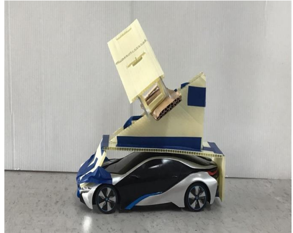
（照片 4-11）架自製三軸傾斜基座的遙控車
