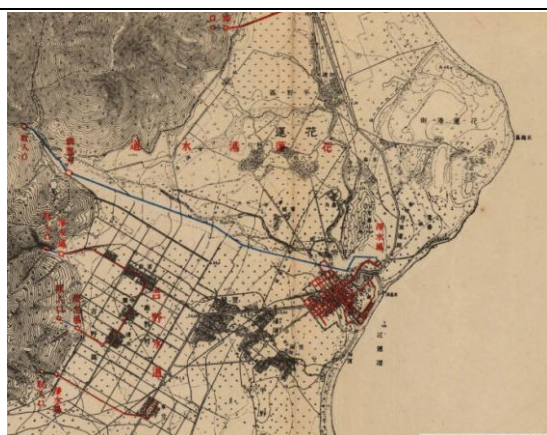
圖 3：1941(1904)花蓮港市水道圖(黑白) 以 1904 台灣堡圖為底圖，繪出 1941 年花蓮市自來水道分布圖，可見現今美崙山淨水場的自來水來自古美崙溪(藍色標線)。
