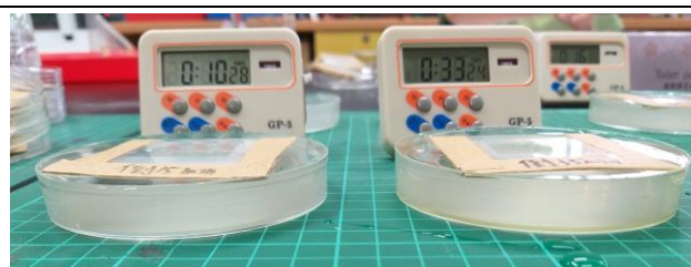
圖三-三-2 反放實驗裝置， 海藻酸鈣由上往下生成
