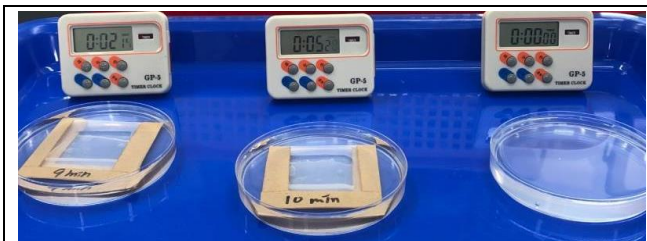
圖三-三-1 正放實驗裝置， 海藻酸鈣由下往上生成
